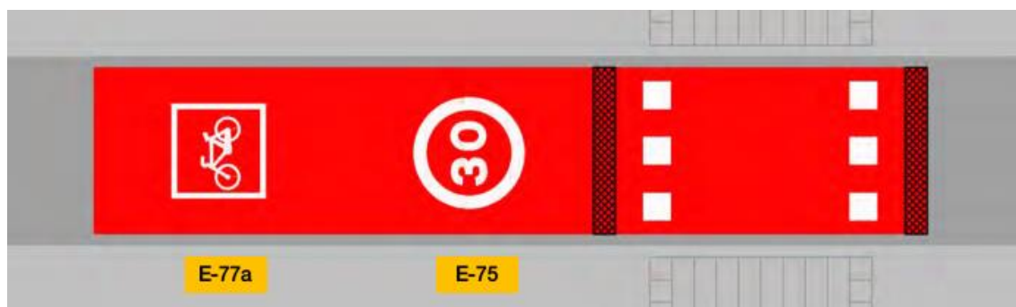
Figura 61. Exemple d'accés a carrer de zona 30: Pas de vianants elevat per reduir la velocitat dels vehicles i senyalització horitzontal
