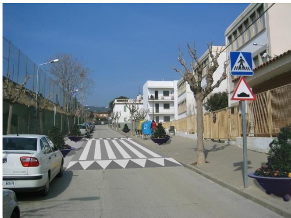
Figura 74. Fotomuntatge proposta de carrer amb paviment únic i preferència per a vianants. Velocitat límit de 20 km/h
