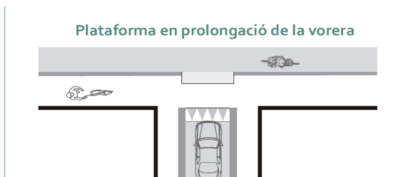
Figura 26. Plataforma en prolongació, plataforma per a vianants
