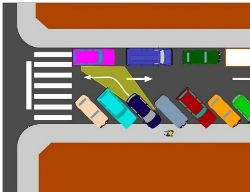
Figura 53. Sortida semibateria amb visibilitat insuficient
