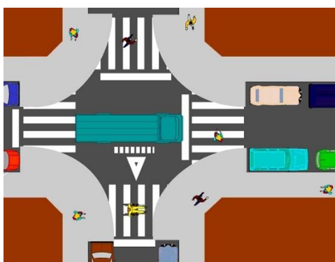
Figura 48. Intersecció compacta i segura
