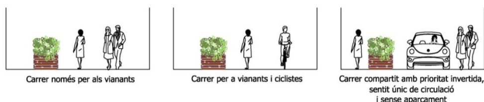
Figura 30. Possibles seccions per a carrers amb menys de 7 m d'amplada
