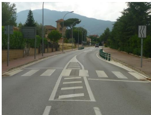
Imatge 61. Exemples de mesures de fàcil aplicació per l'estretament d'amples de calçada
