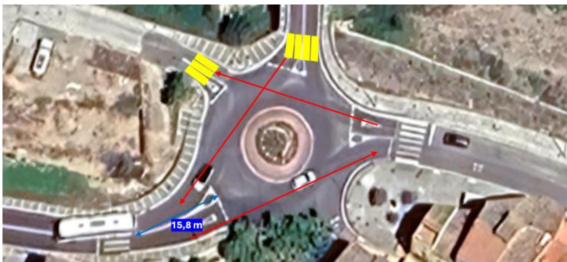
Figura 22. Disfuncions de la rotonda carretera T-7001 i T-700 amb av. de Catalunya i c. de la Font
